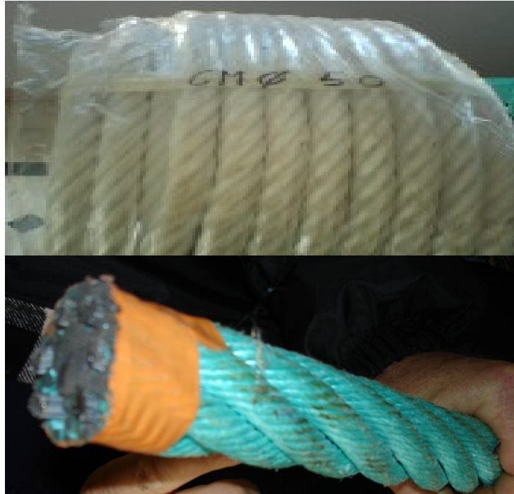
صورة رقم (11): الحبال المزدوجة والمركبة المستعملة في صناعة معدات الصيد
